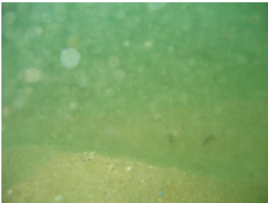
Foto 31 – Fotografia subaquática junto ao fundo (15 m), evidenciando a visibilidade extremamente reduzida (0.5 a 1 m), a natureza arenosa do sedimento e a grande quantidade de matéria sedimentar em suspensão.
