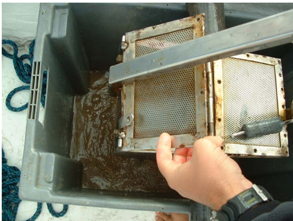
Foto 20 – Recolha de sedimento com uma draga van Veen.
