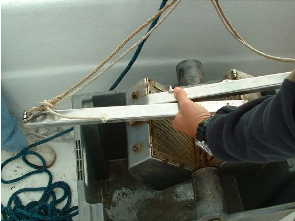
Foto 17 – Amostragem da comunidade bentónica com uma draga van Veen.
